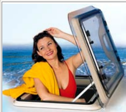
0100550 Katuseluuk Seitz Heki 1, paigaldusava 960x655mm, kasutusava 790x510mm kaks avamisvõimalust, vääntamismehhanism ja käepidemed vändaga luuk avaneb 70° pimendus- ja sääsevõrgu kassett 27-60mm paksuse katuse jaoks
