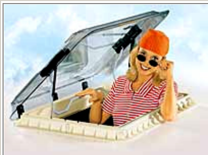
0100560 Katuseluuk Seitz Heki 2, paigaldusava 960x655mm, kasutusava 780x530mm avatakse käepideme kangi abil, luugil on gaasvedrud, mis hoiavad seda lahti kolm avamisasendit, 12mm, 150mm ja täiesti lahti, mil luuk avaneb umbes 55° pimendus- ja sääsevõrgu kassett 25-60mm paksuse katuse jaoks
